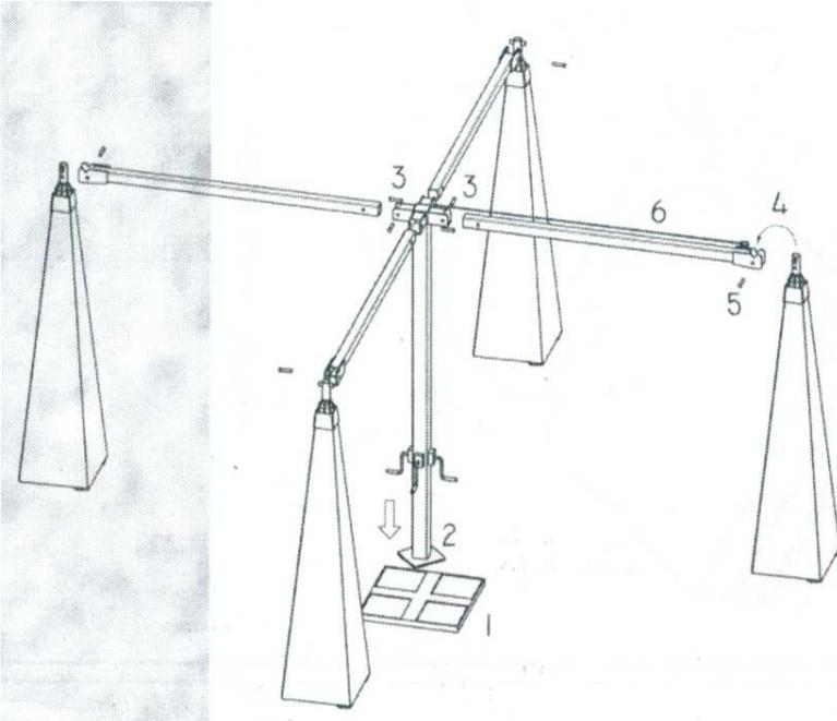
3. Inserire braccia laterali e fissarli con le apposite viti (fig. B).
